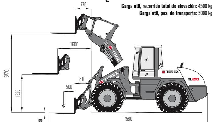
Carga útil, recorrido total de elevación: 4500 kg
