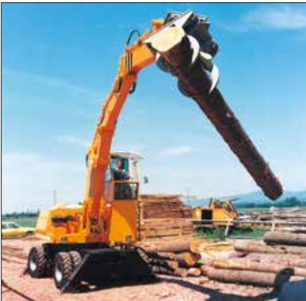
1974: Holz-Umschlagmaschine mit erhöhter Fahrerkabine
