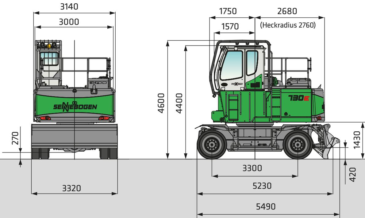
730 M mit 1 m starr vorklappbarer Kabine, Unterwagen Typ MF36E
