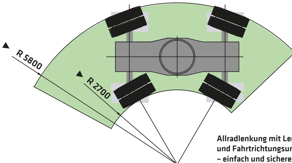
Allradlenkung mit Lenkrichtungs- und Fahrrichtungsumschaltung - einfache und sichere Bedienung für maximale Effizienz!
