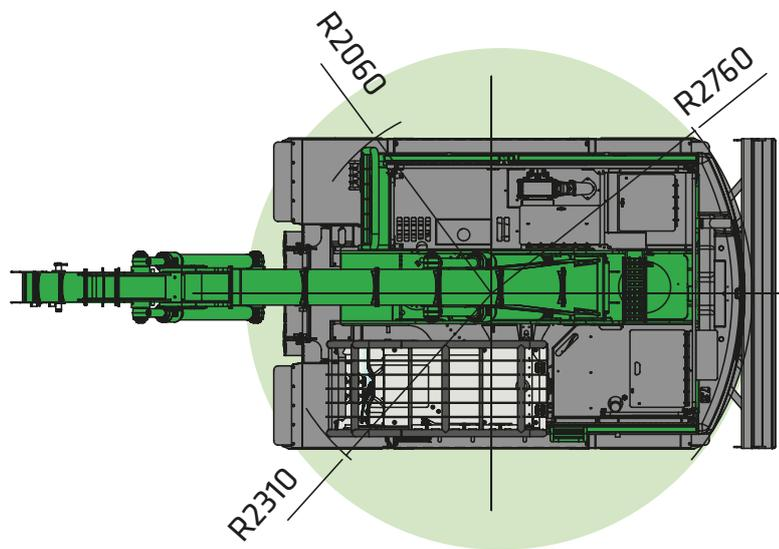
Kompakteste Abmessungen für mehr Lagerplatz, dadurch weniger Verkehrsfläche! Kompakte Oberwagenabmessungen für den Einsatz in beengten Bereichen. Platzsparende, optimale Wendigkeit und Sicherheit!
