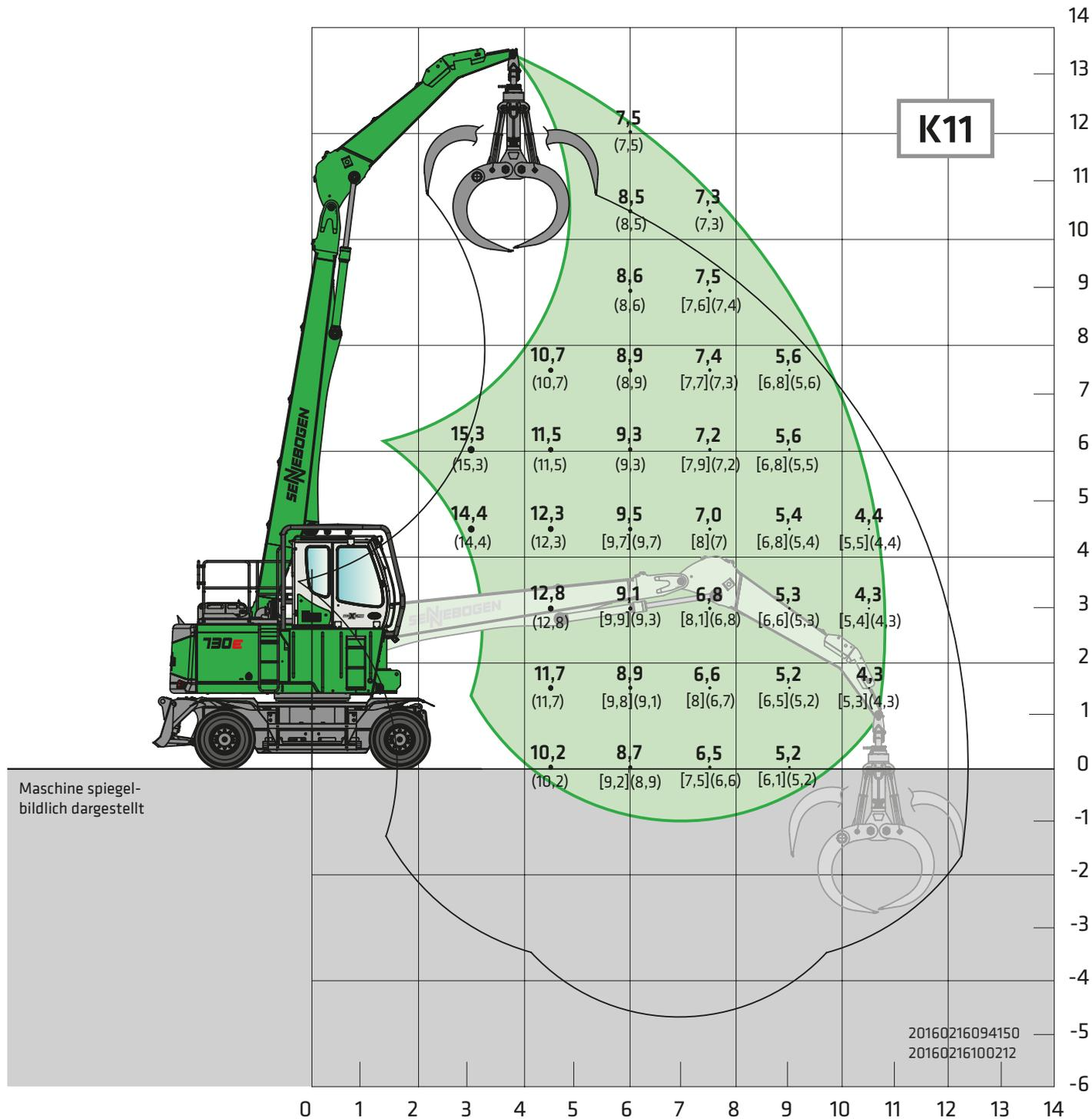
**Unterwagen MF36E      Kompaktausleger 8,0 m      Kabine maXcab, 1m starr erhöht**
