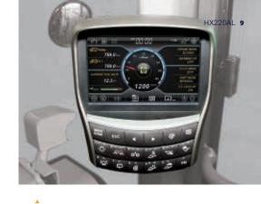
El panel de instrumentos está optimizado para proporcionarle un acceso rápido y sencillo a la información sobre el estado de la máquina mientras trabaja. Incluye un monitor táctil de 8 pulgadas para una legibilidad excelente.
