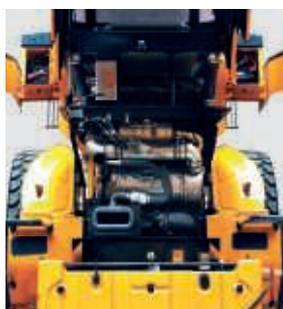
El **capó es totalmente retráctil** y puede **abrirse eléctricamente** para facilitar el acceso al compartimento del motor sellado y al compartimento de refrigeración. El compartimento del motor está diseñado para evitar la posibilidad de incendio a causa de la entrada de cuerpos extraños.
