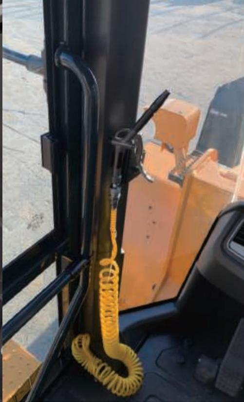
Se puede montar un **compresor de aire** opcional en la cabina para ayudar a los operadores a mantener su espacio de trabajo agradable y cómodo.
