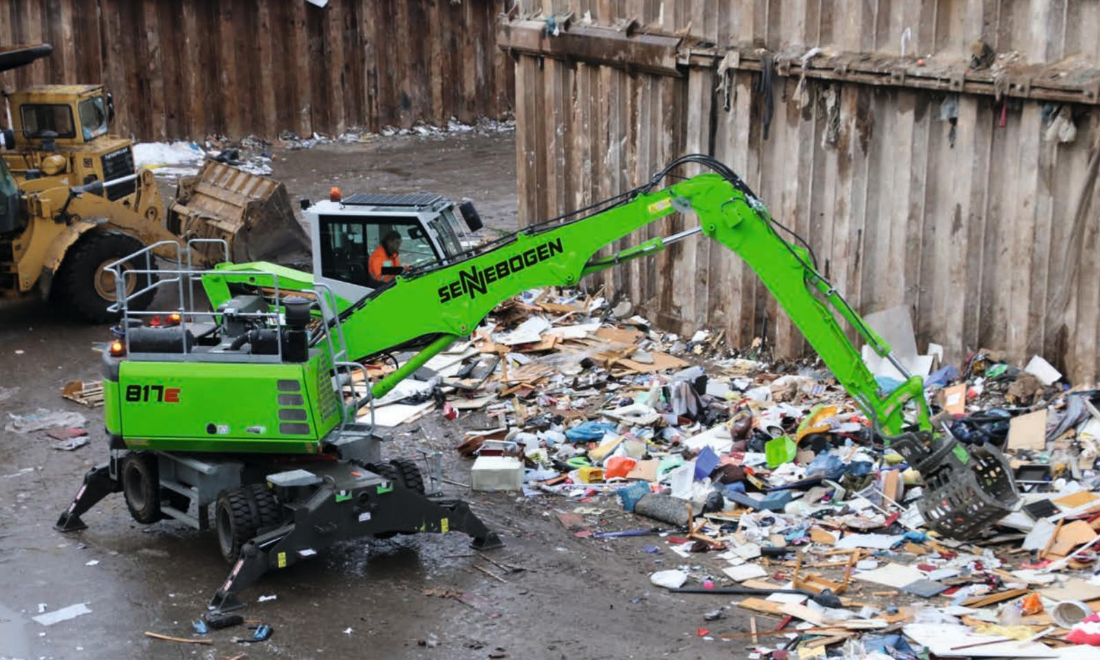
817E - moderna excavadora para trabajos de clasificación rápidos y delicados en el reciclaje de residuos
