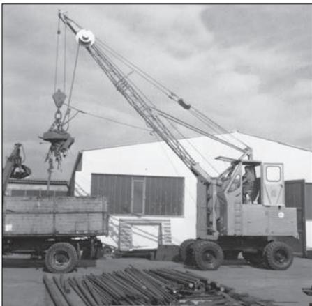
1962: S833 operado con cables con cabina para el conductor elevada
