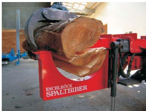
El Spaltbiber también se puede montar sobre los tres puntos en montaje trasero o delantero. También puede ir montado sobre la base de la grúa. Después de rajar la madera puede secar más rápido, ideal para su posterior astillado.
