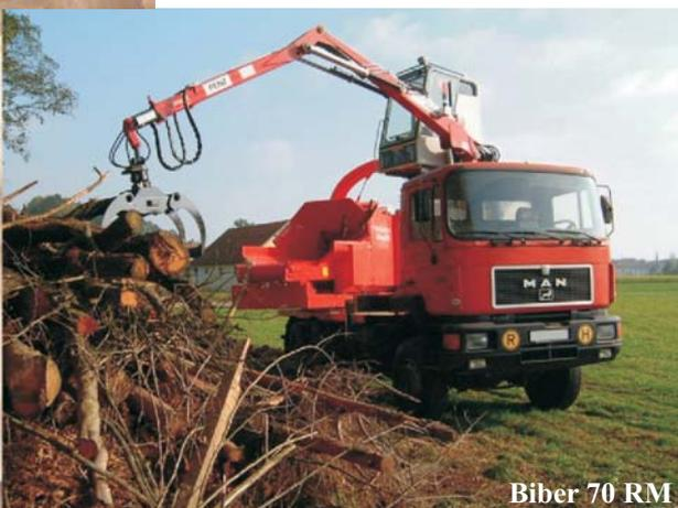
La gama Biber 70 fue desarrollada por una demanda de alimentar el astillador mediante grúa. Como características importantes reseñar un sistema potente de tracción de entrada de la madera mediante dos rodillos en la parte superior y una cinta de cadena abajo.
