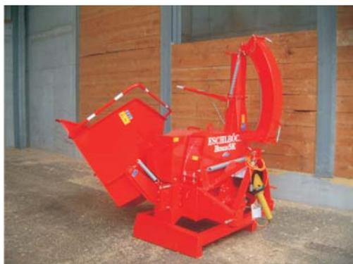
Las cuchillas del disco pueden ser afilados en la misma máquina sin tener que ser desmontadas.
