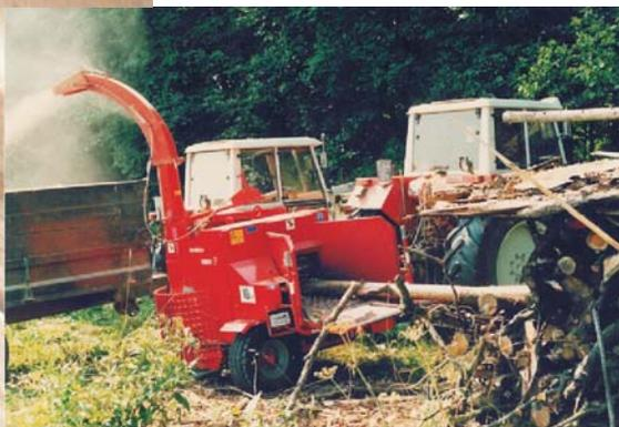
En 1992 se fabricó el Biber 7 con una boca de alimentación de 35 x 56 cm. Con su robusto tambor con cuchillas colocadas por parejas se consigue un astillado regular y fácil.
