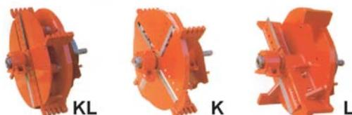
El sistema especial de alimentación mediante rodillo junto al ángulo de las cuchillas optimizan el esfuerzo de corte incluso en diámetros grandes de troncos.
