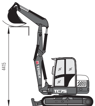
Fig. 2: Pluma “Circular” - altura útil
