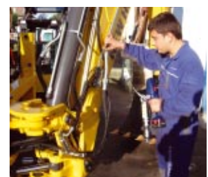
Engrase de la retro, 18 puntos centralizados.
