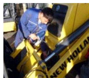
Con este distribuidor, lubricamos los 20 puntos de engrase de la pala frontal.
