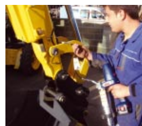
Al ser extensible, hemos agrupado los 6 puntos del cazo en un distribuidor.
