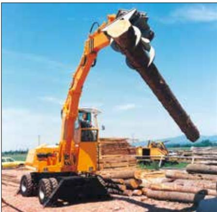
1974: Holz-Umschlagmaschine mit erhöhter Fahrerkabine
