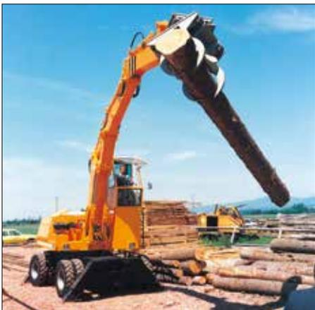
1974: Holz-Umschlagmaschine mit erhöhter Fahrerkabine
