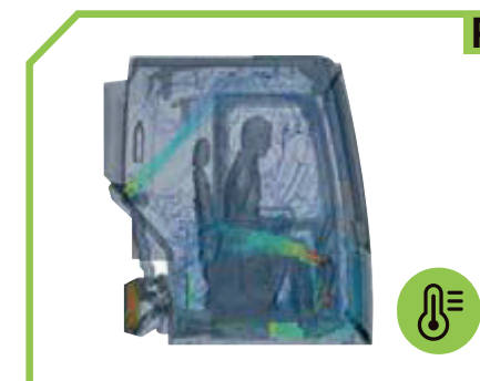
La nueva generación de cabinas tiene un efecto refrigerante de más del 19% en comparación con la generación anterior.
