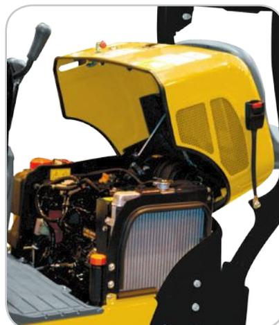
Capó de amplia apertura que permite acceso rápido a todos los órganos principales. Protección lateral desplazable rápidamente.
