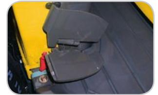
Pedal de la toma de fuerza y pedal para orientar la pluma, con cubiertas de protección retráctiles que evitan cualquier riesgo de movimiento no deseado.
