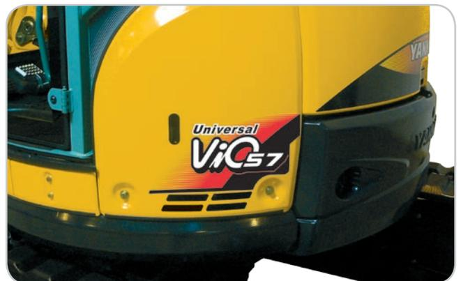
> Forma del contrapeso diseñada para proteger las planchas laterales contra posibles golpes. Colocación de piezas moldeadas en el chasis superior en los ángulos exteriores derecho e izquierdo que mejoran la resistencia a los golpes.
