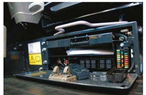
A las correas del ventilador se accede mediante una trampilla en la parte exterior derecha de la cabina. La batería está protegida por una placa metálica detrás del capó trasero derecho, y los elementos eléctricos se encuentran debajo del asiento.
