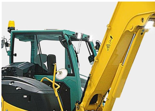
energético bajo, y aumenta la duración de la batería. Pueden añadirse opcionalmente un faro giratorio y un faro LED adicional en la parte trasera de la cabina.
