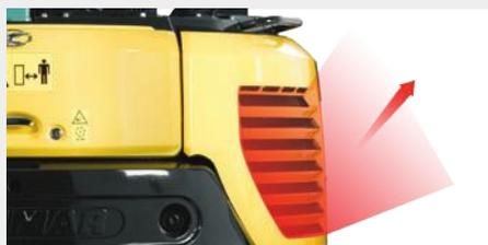
Evacuación del aire de refrigeración del motor orientada hacia arriba (protección de las personas y plantas en el entorno)
