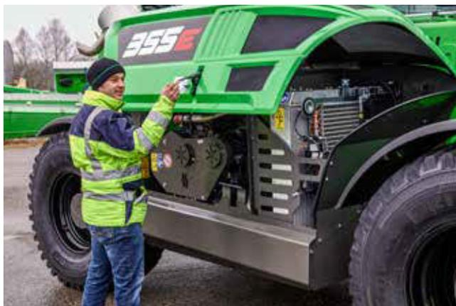
Amplio acceso al compartimento del motor en un solo paso. La placa lateral de la góndola del motor también se puede desmontar.
