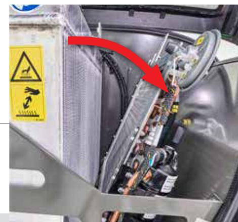
Muy buen acceso al radiador gracias al condensador plegable del aire acondicionado / refrigerador de combustible.
