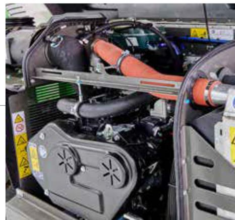
Fácil acceso a todos los puntos de servicio gracias al motor montado transversalmente.
