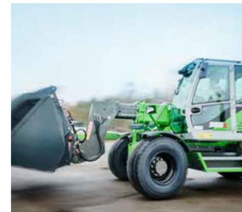
Máx. 40 km/h, velocidad de conducción
