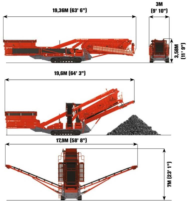
La Terex® Finlay 693+ de dos pisos se ha diseñado y desarrollado para satisfacer las exigencias de los fabricantes de alta producción de hoy en día. La configuración de criba de dos pisos proporciona dos pisos de criba de tamaño completo de 6,1 x 1,53 m (20' x 5').
