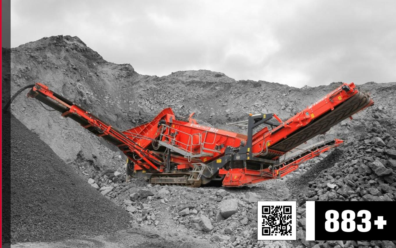
La cuarta generación de Terex Finlay 883+ se ha desarrollado como un precribador de servicio pesado, versátil y de alta capacidad destinado a utilidades de cribado primarias y secundarias como canteras y minería, mineral de hierro, escombros de demolición, arena, grava, compost, tierra vegetal y carbón.
