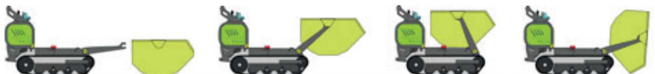
El dispositivo patentado para el enganche rápido de los accesorios, que equipa el carro con dos fuertes brazos mecánicos, es la base tecnológica de los Cingo Multifunción. Gran parte de los accesorios del sistema Multifunción son compatibles con este dispositivo.
